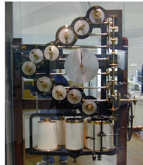
Computador de marés: previsão da altura das marés (~1800, Lord Kelvin)
